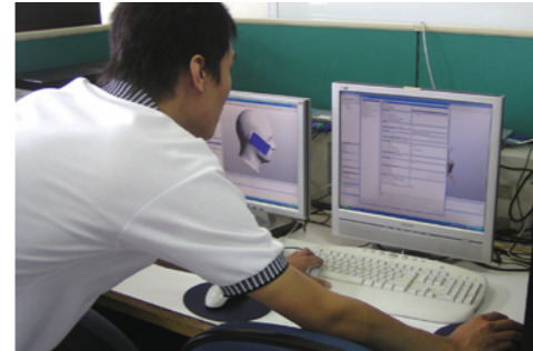
▲ 研究人員只要設定好天線以及人體頭部模型的參數(圖中右方螢幕)，電腦模擬軟體即可模擬使用者使用手機的狀況(圖中左方螢幕)。 (圖片拍攝 / 葉基)
